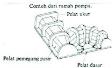
Gambar 3.12 Pola Kerangka A Sumber: Surdia dan Chijiwa (1986,p.59)
