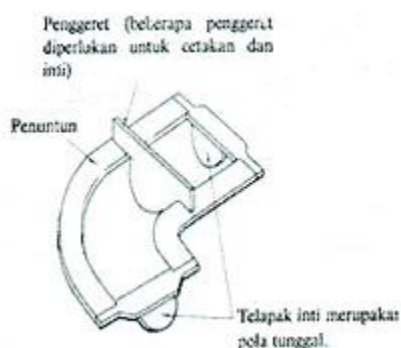
Gambar 3.10 Pola Penggeret dengan Penuntun Sumber: Surdia dan Chijiwa (1986,p.58)
